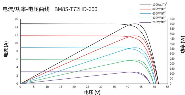
电流-电压曲线 BM8S-T72HD-600
